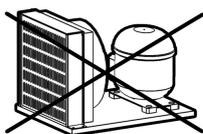
Possibile predisposizione per unità condensatrice remota
